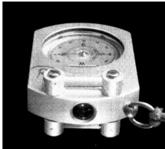
Fig. 1: Ansicht eines SUUNTO-Kompasses mit aufgesetztem Glaszylinder. Das vom Zielpunkt ausgehende Licht erscheint im Glaszylinder als senkrechter Strich und erlaubt damit eine korrekte Peilung auch bei steilen Strecken. Mit diesem System werden alle Fehler ausgeschaltet, welche sich durch das fehlerhafte Abschätzen der senkrechten Verlängerung des Peilstriches ergeben. Vor allem bei steilen Strecken (über 30° Neigung) können diese Fehler unerwartet gross sein. System und Montage sind in Weissensteiner & Trüssel (1991) im Detail beschrieben. Photo M. Trüssel.
